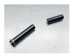
Danneggiamento dell'elemento interno A causa del cattivo tempismo serraggio dell'iniettore.
